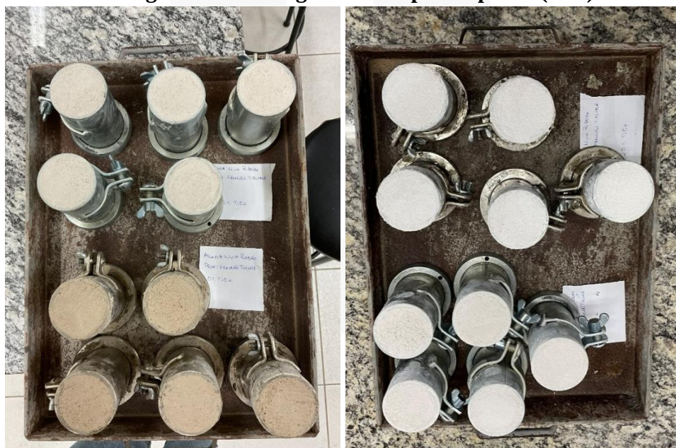
Figura 02: Moldagem dos corpos de prova (CPs)
