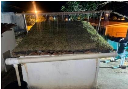
Figura 8 – Simulação da chuva no telhado verde.
