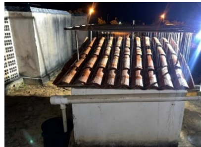
Figura 9 – Simulação da chuva no telhado convencional.
