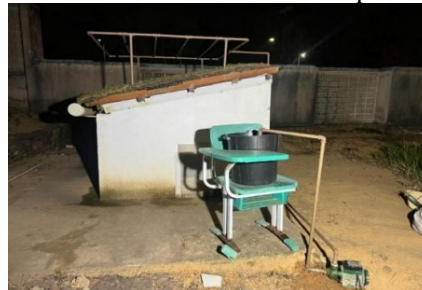
Figura 10 – Sistema de bombeamento utilizado para simulação da chuva.
