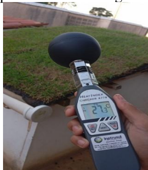
Figura 7 – Coleta de temperaturas usando o globo preto no protótipo
