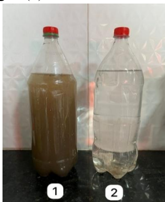
Figura 15 – Qualidade da água (1) ao telhado verde e (2) ao telhado convencional.
