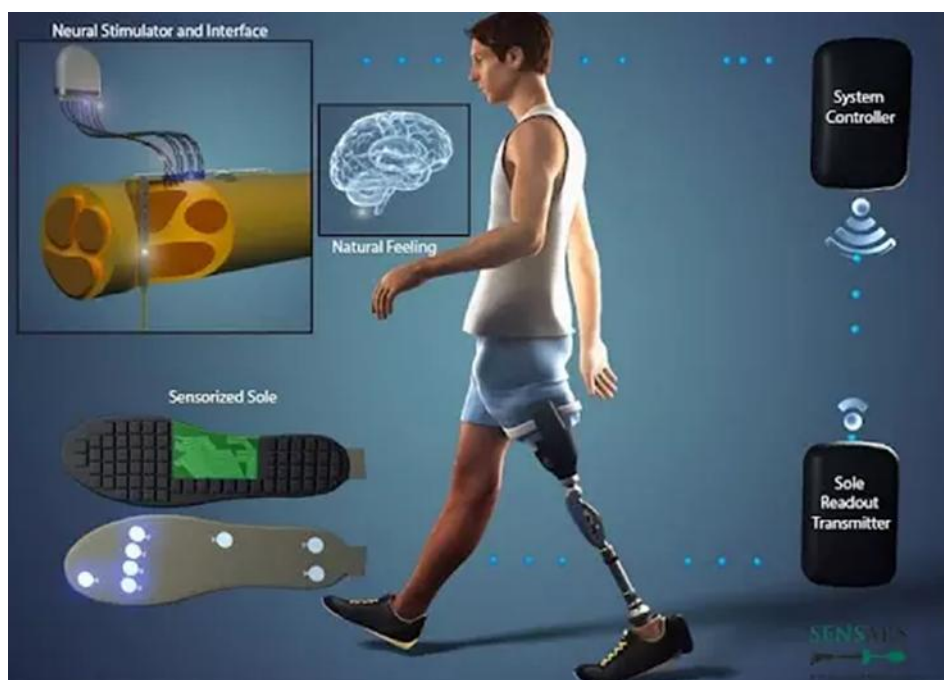
Figura 1 – Representação esquemática de uma prótese biónica inteligente com interface neural e sensores integrados.
