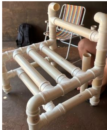
Figura 1 – Cadeira de banho adaptada confeccionada pelos estudantes utilizando tubos de PVC e materiais reaproveitáveis Fonte: Galeria pessoal (2025)
