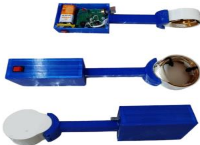
Figura 2 – Protótipo montado do detector de metais.
