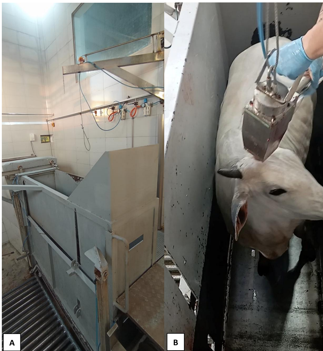
Figura 4 – A) Box de insensibilização destinado à contenção dos bovinos durante o disparo. B) Colaborador realizando a insensibilização com pistola pneumática de pino cativo penetrante.
