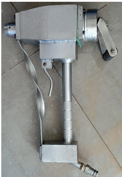
Figura 1 – Pistola de pino cativo penetrante usada para insensibilização de bovinos.
