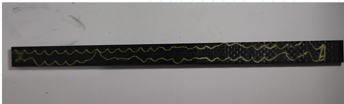
Figura 1 – Corpo de prova pós remoção da resina superficial.
