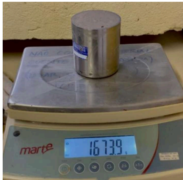
Figura 4 – Recipiente preenchido com argamassa para ensaio de densidade.
