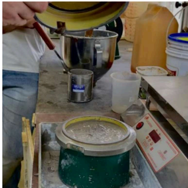
Figura 5 – Pressiométrico com argamassa.
