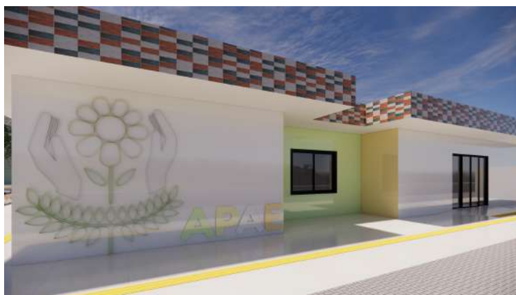
Figura 42 - Fachada com painéis e logo em ACM
