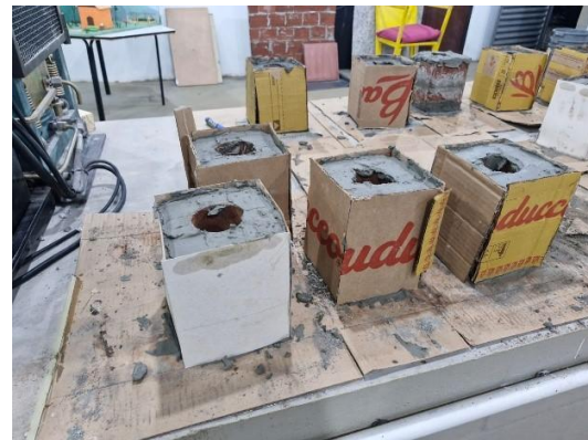
Imagem 3 – (a) corpo de prova capeado e (b) moldes de papelões para o capeamento.
