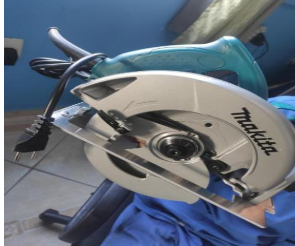
Imagem 2 – Serra Circular utilizada no corte dos tijolos.
