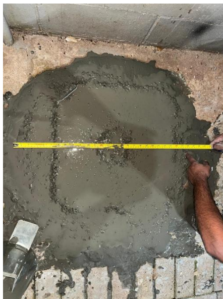
Fotografia 15(a) e 15(b): Slump flow e T500 do CAA com aditivo impermeabilizante A.
