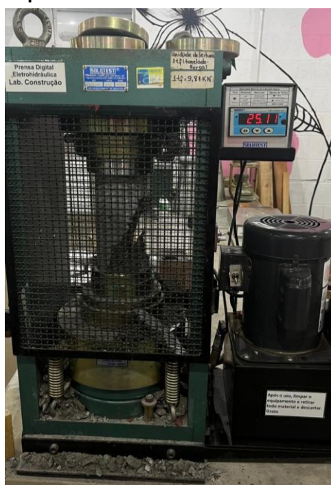
Fotografia 19: Ensaio de compressão axial com 28 dias de cura no CAA com aditivo AI-A
