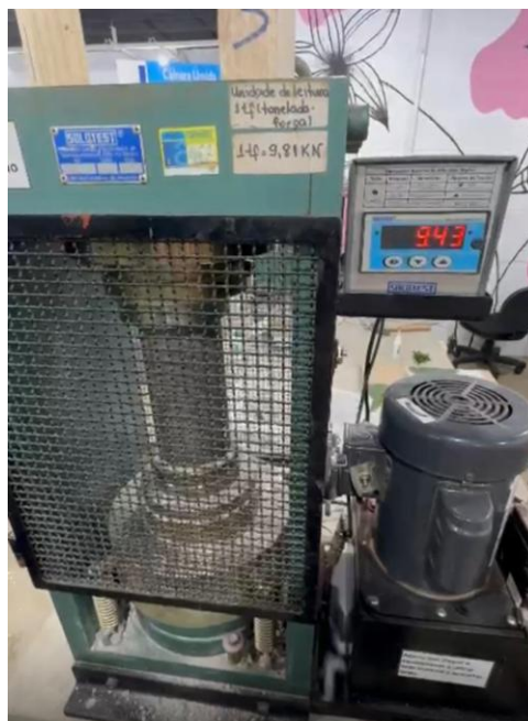
Fotografia 17: Ensaio de compressão axial com 7 dias de cura no CAA sem aditivo AI.
