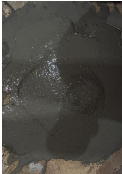
Fotografia 14: Slump flow e T500 do CAA sem aditivo impermeabilizante.
