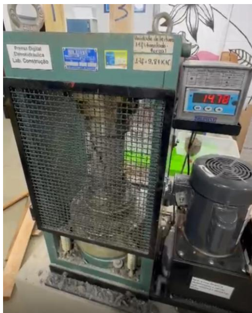
Fotografia 18: Ensaio de compressão axial com 14 dias de cura no CAA com aditivo AI-B
