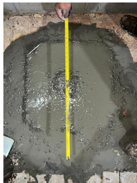
Fotografia 15(a) e 15(b): Slump flow e T500 do CAA com aditivo impermeabilizante A.
