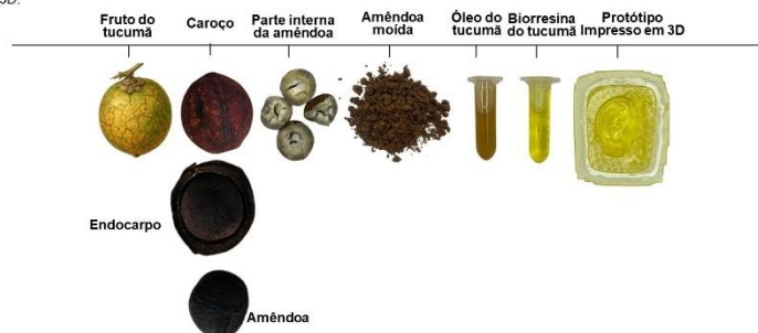
Figura 7- Sequência de processamento do fruto do tucumã até a obtenção do protótipo impresso em 3D. Da esquerda para direita: fruto do tucumã, caroço do tucumã, amêndoa do tucumã moída, amostra de óleo funcionalizada, protótipo impresso em 3D.
