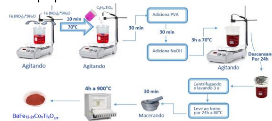
Figura 1. rota de síntese por coprecipitação.
