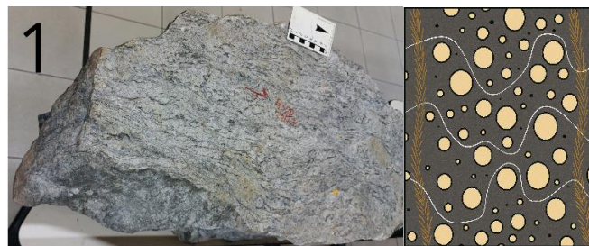
Figura 1. Apresenta a amostra coletada em campo e um desenho esquemático da mesma demonstrando a textura e a ação deformacional das zonas de cisalhamento no milonito porfiroclástico.
