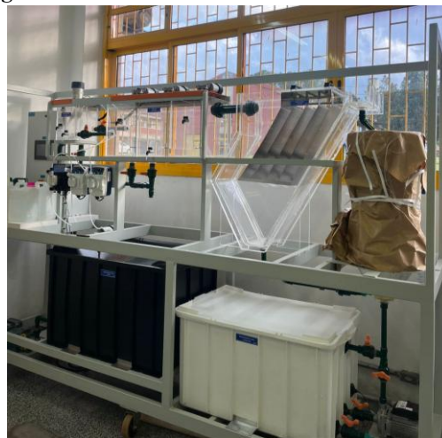
Figura 2 - Módulo didático de Tratamento de Água
