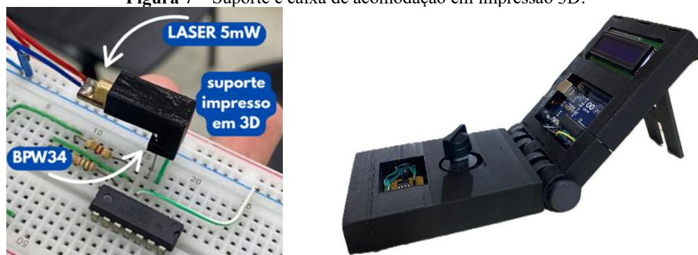
Figura 7 – Suporte e caixa de acomodação em impressão 3D.
