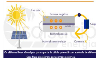
Figura 3. Funcionamento das Células Fotovoltaicas.
