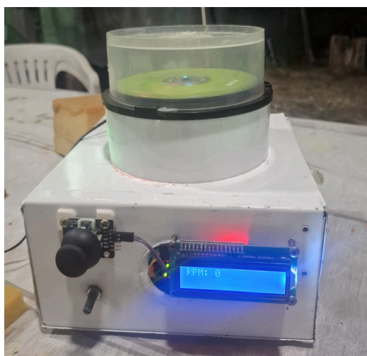
Figura 2. Design final do spin coater, desenvolvido no Laboratório de Desenvolvimento e Aplicações de Nanomateriais da Amazônia (LADENA), seguindo toda a metodologia abordada. (Fonte: Ilustração Própria, 2025)
