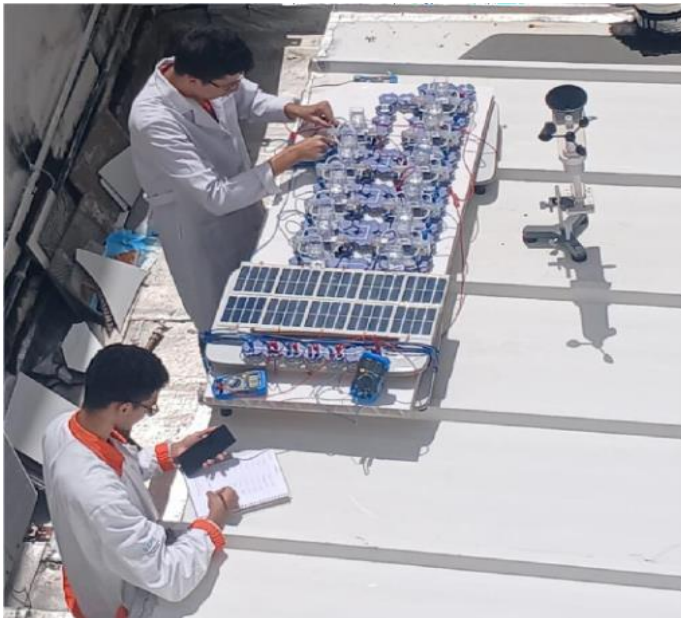
Figura 05: Conjunto de painéis solares alimentando o sistema de geração de hidrogênio com a associação a série de PEMFCs.
