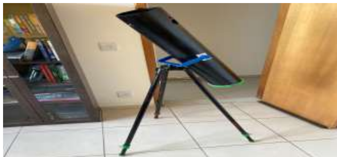
Figura 8 – Construção do telescópio refletor. Fonte: Arquivo do projeto.
