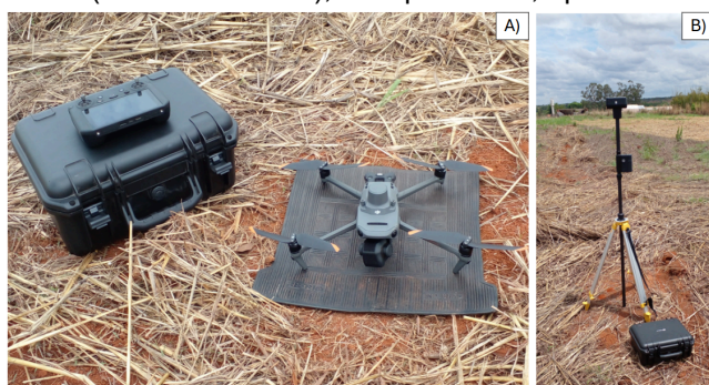
Figura 2 - Equipamentos utilizados: (A) DJI Mavic 3 Enterprise, (B) Estação Móvel DJI D-RTK2.
