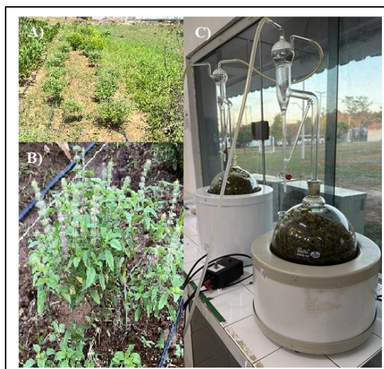
Figura 1- Ocimum americanum e Hidrodestilação em aparelho tipo Clevenger
