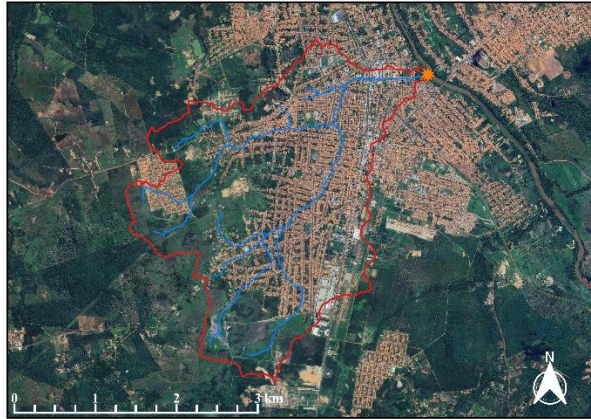
Figura 4: Área da bacia em imagem de satélite, destacando a área urbana e a rede de drenagem.
