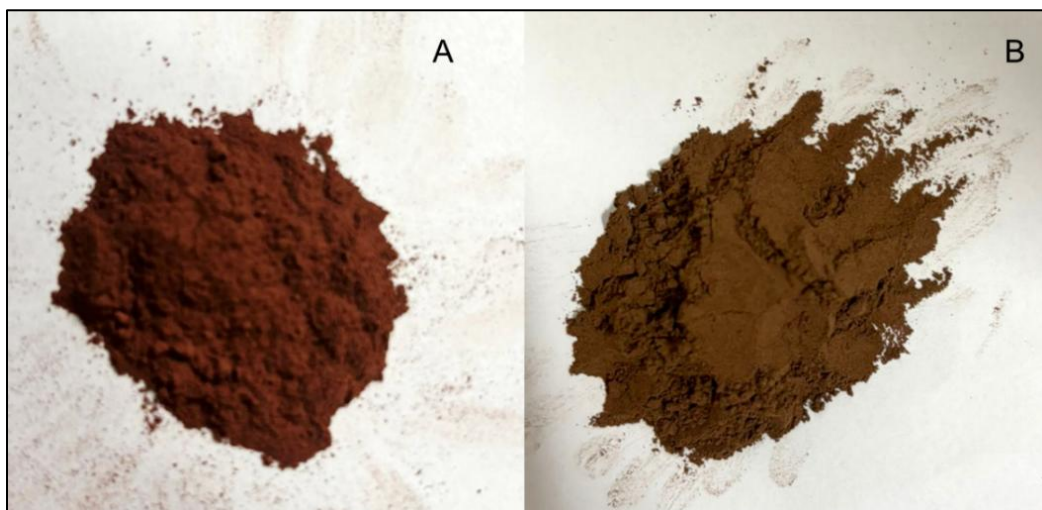
Figura 2 - Cinzas do lodo gerado na ETE Anil obtidos nas temperaturas de 450°C (A) e 650°C (B)
