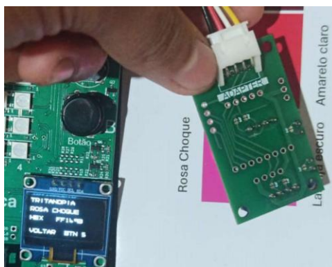
Figura 1 – Leitura do sensor de cor
