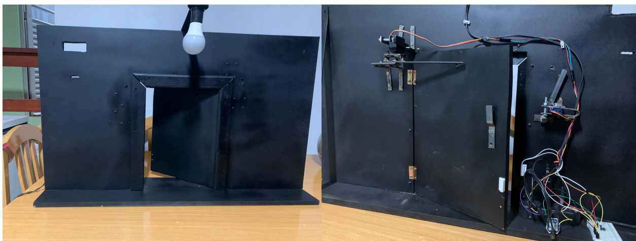
Figura 3 - Motor de travamento da porta e motor de fechamento da porta
