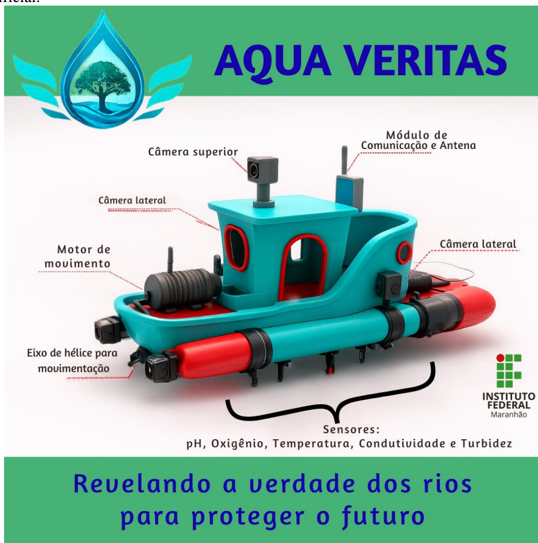
Figura 1 – Protótipo do Drone “AQUA VERITAS” criado a partir de inteligência artificial.
