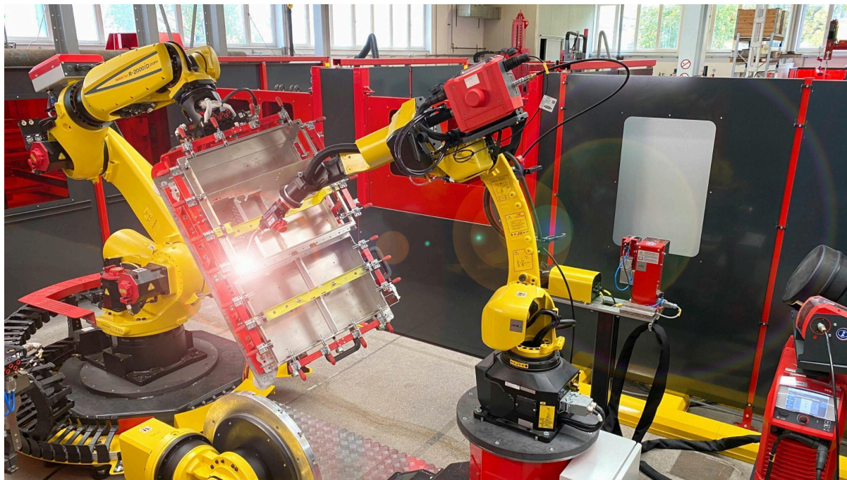
Figura 2: Robôs atuando em processo de solda
