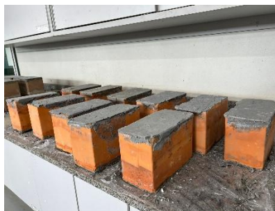
Figura 6: Blocos regularizados com capeamento.
