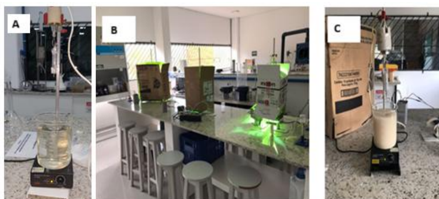
Figura 7 - Reator fotocatalítico (A) Reator fotocatalítico protegido (B,C)
