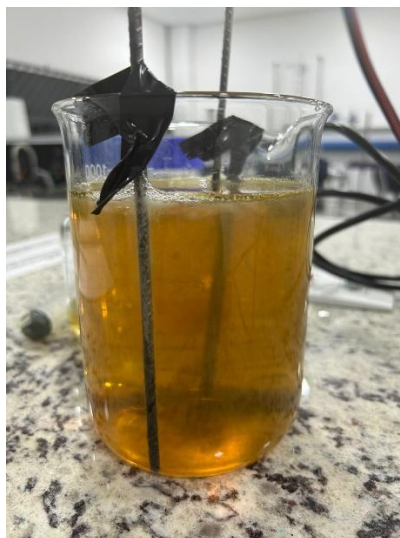
Figura 1 – Efluente durante o processo de eletrofloculação
