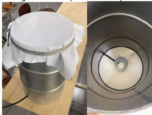
Figura 3 – Protótipo do silo de explosão
