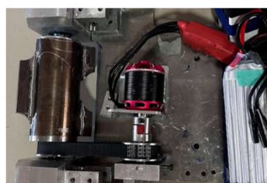
Figura 11 – Sistema de arma com cilindro rotativo e sistema de acionamento.
