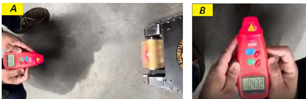
Figura 12 – Medição da rotação máxima do cilindro da arma.
