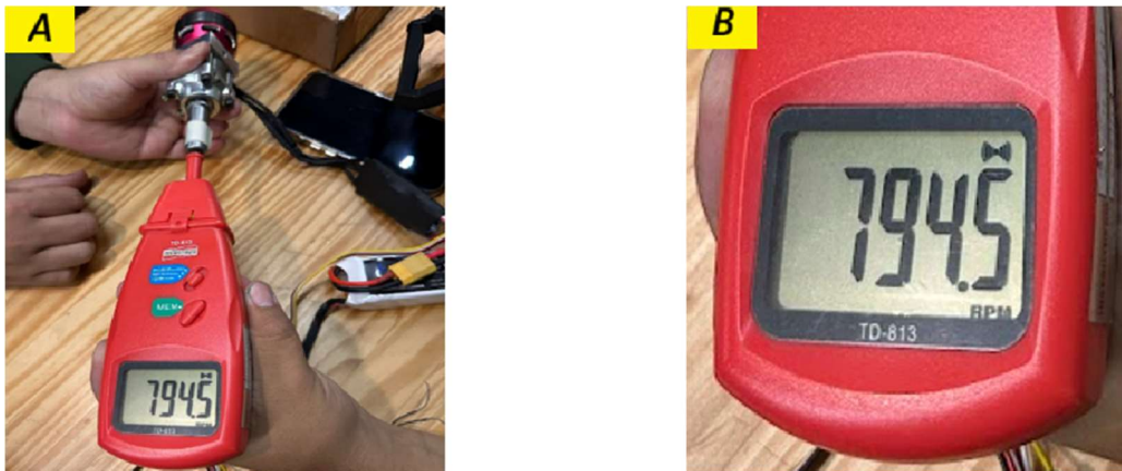
Figura 5 – Teste velocidade final do redutor com tacômetro digital
