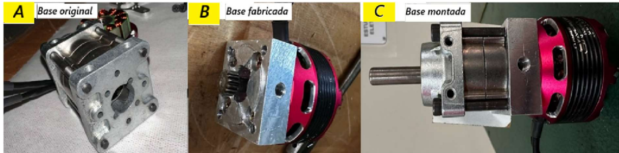
Figura 6 – Adaptação com uma nova base no redutor.
