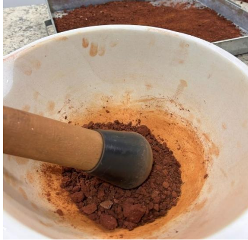
Figura 2: Utilização do equipamento almofariz e pistilo.
