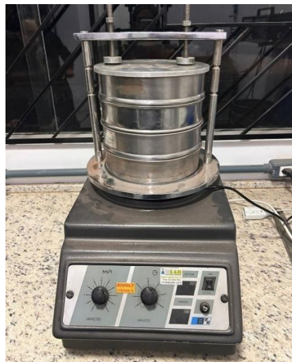
Figura 3: Utilização da peneira automática.
