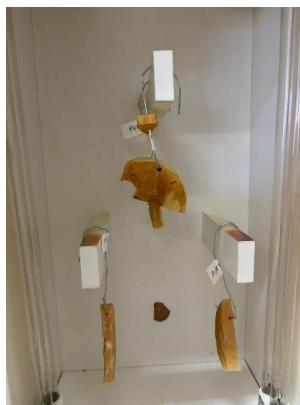
Figura 1 - Câmara de envelhecimento de UV com as amostras de poliuretanos
