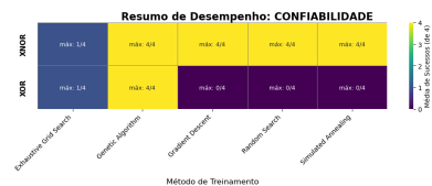
Fig. 1. Confiabilidade para o critério de parada de E_{total} < 0.5 . Cada célula representa a maior razão entre saídas corretas e total de saídas obtida em todas as execuções do treinamento.
