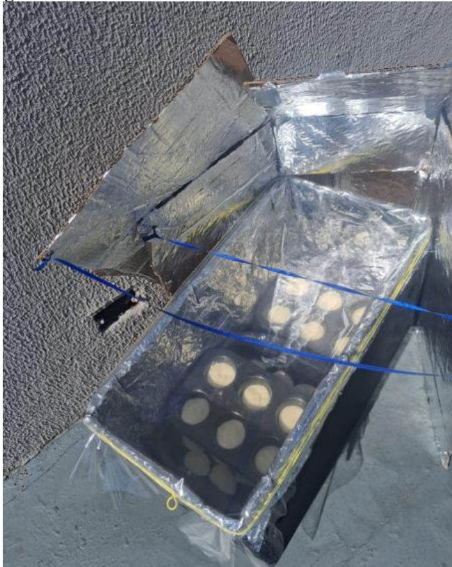
Figura III: Biscoitos sendo assados no forno solar de caixa
