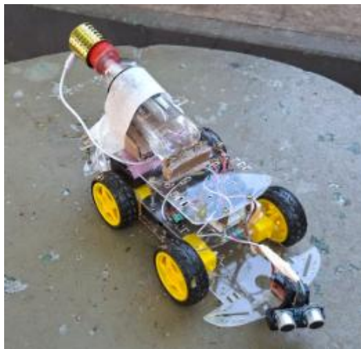
Figura 1: Protótipo do robô autônomo com chassi 4wd e mecanismo de dispersão de citronela
