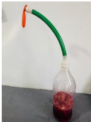
Figura 1: Modelo de biodigestor confeccionado pelos clubistas
