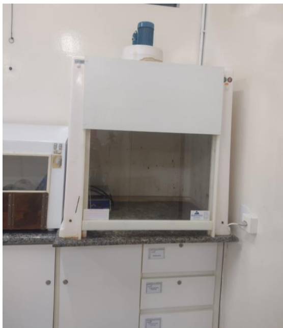
Figura 4 - Capela de exaustão presente no laboratório de química.
