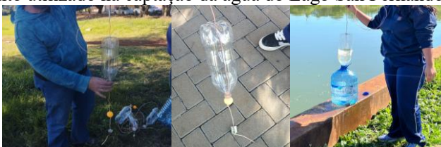
Figura 4 – Equipamento utilizado na captação da água do Lago San Fernando (Rolândia/PR)
