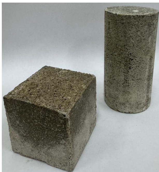
Figura 2: Exemplos de corpos de prova desmoldados. Fonte: Os autores (2026)
