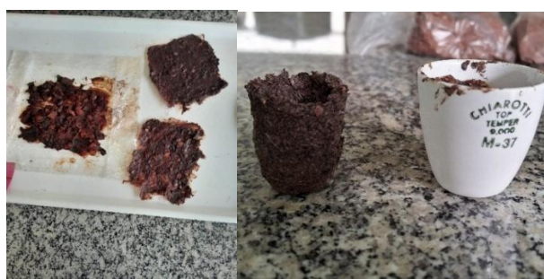
Figura 2: Bioplástico associado a sementes de salsa e rabanete acomodado nos moldes de porcelana e processo de secagem do copo e das placas.
