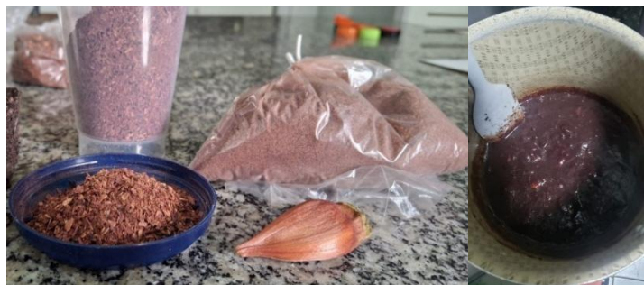
Figura 1: Cascas de pinhão cozidas, secas e trituradas e cozimento do bioplástico.
