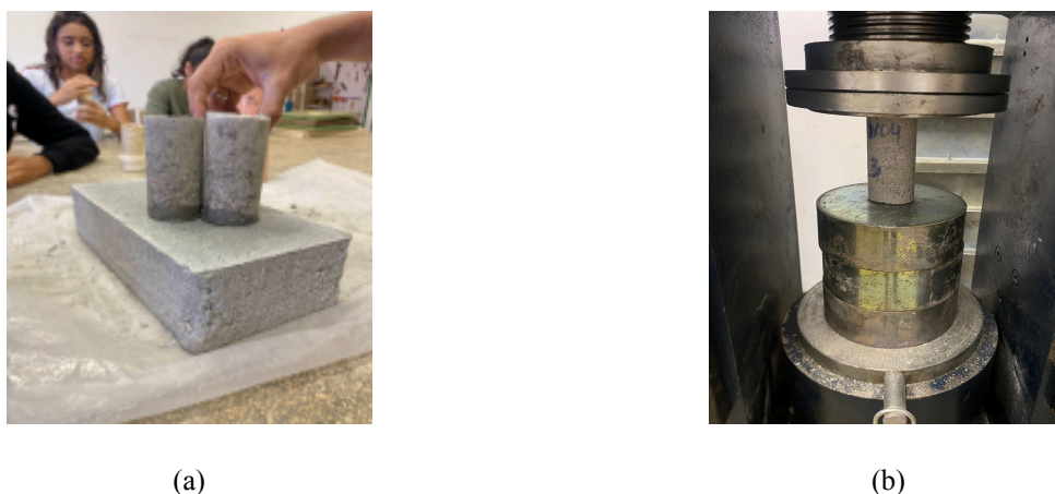
Figura 4 - Avaliação da resistência mecânica: a) Corpos de prova e b) Ensaio de compressão.
