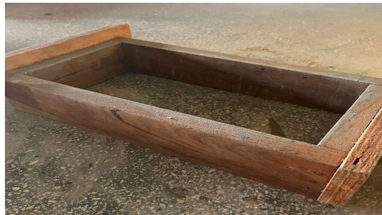
Figura 1 - Forma de madeira utilizada para fabricação dos blocos.
