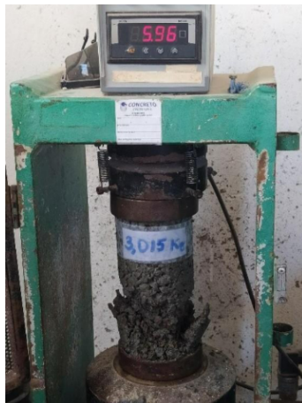
Figura 3 - Ensaios em andamento: (a) Compressão, (b) Permeabilidade.
