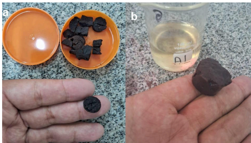
Figura 1 - Hidrogel a base de amido de babaçu, laponita e quitosana a) seco e b) após equilíbrio de absorção de água
