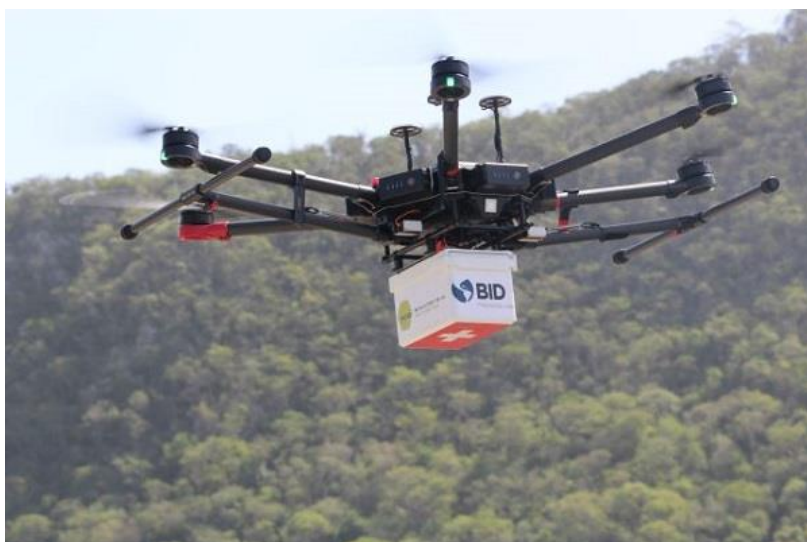
Figura 5 – Drone com caixa acoplada para entrega de suprimentos médicos
