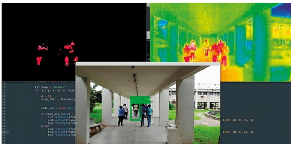
Figura 6 – Imagens de câmera térmica acoplada a um drone
