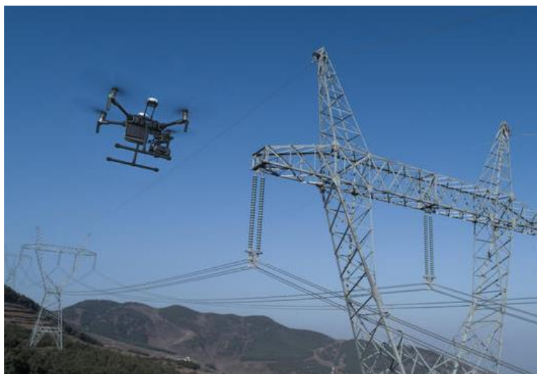
Figura 4 – Drone utilizado para inspeção de linhas de transmissão de energia
