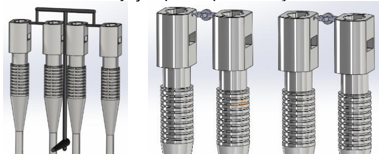
Figura 1b – Novo canal de injeção pós implementação de câmara quente.
