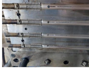
Figura 6 – Molde após implantação da câmara quente
