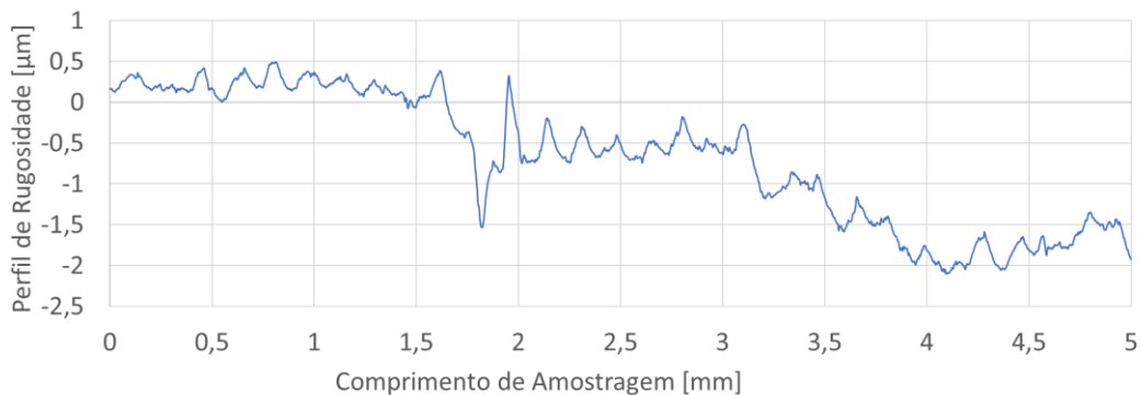
Figura 3. Perfil de rugosidade com balanço de 30mm.
