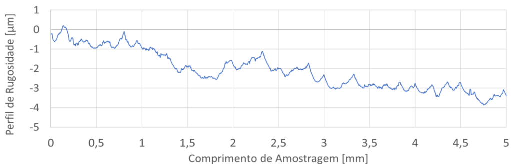
Figura 4. Perfil de rugosidade com balanço de 80mm.
