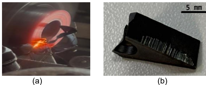
Figura 1. Desgaste da ferramenta na superfície de folga do inserto (a) durante o processo de torneamento e (b) a quebra do inserto após o processo.
